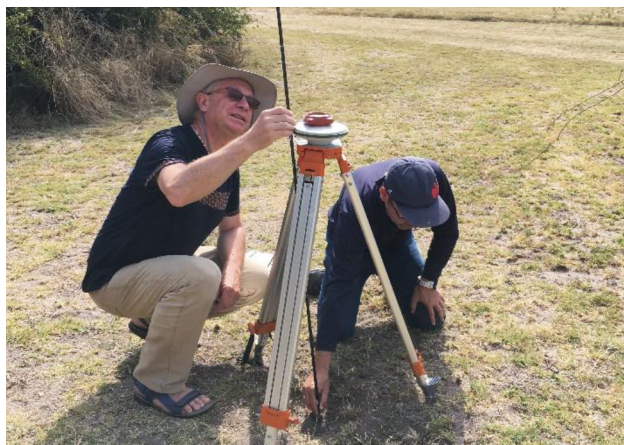
Installation d'une antenne GPS
